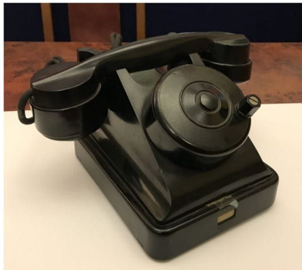
Телефонный аппарат типа МБ с питанием от местной батареи. 1952 г.
